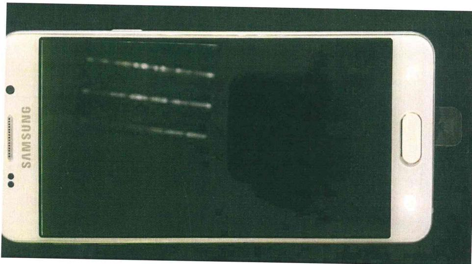
В связи с изложенным, нельзя однозначно утверждать, что неисправность сотового телефона Samsung A310 Galaxy A3, носит эксплуатационный характер, так как, ни каких механических повреждений не обнаружено.
